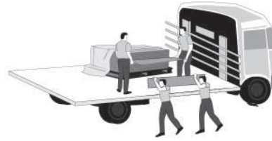
Transporte e proteção de placas cimentícias.
